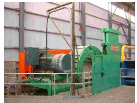
entspannt und, abhängig von der Maschinengröße, werden bis zu sechs Messerpakete gleichzeitig gewechselt. Die Stillstandzeit für Messerwechsel kann hierdurch wesentlich verkürzt werden.
