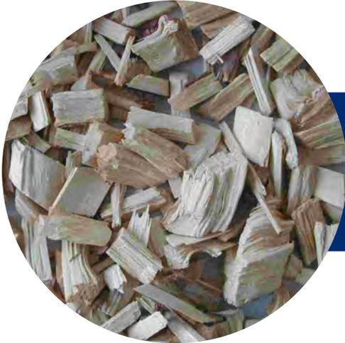
Mit PALLMANN-Trommelhackern Typ PHT werden lange und kurze Rundhölzer, Scheite, Sägewerksabfälle, Furniere und sonstige Holzabfälle zu Qualitätshackschnitzeln aufgeschlossen. Zellstoffwerke, Papierfabriken, Faser- und Spanplattenwerke verarbeiten den Rohstoff "Hackschnitzel" in zunehmendem Maße, denn Hackschnitzel sind ein einfach zu transportierendes Gut. Sie lassen
