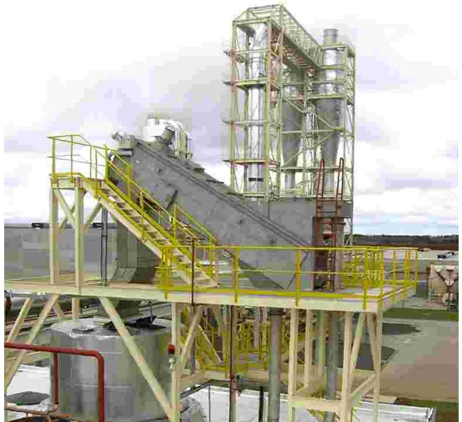
gleichmäßige Materialzufuhr in die Mahlzone. Durch die spezielle sphärisch und hydrodynamisch gelagerte Hauptwelle wird sowohl eine Mahlpalt- oder eine Energiegesteuerte Zerfaserung ermöglicht. Der Refiner wird mit einem 6 MW Motor angetrieben und ist mit 54" Segmenten bestückt. Bereits kurz nach dem Anlagenstart wurden die garantierten
