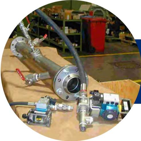
Die Beleimung der MDF-Fasern erfolgt in der industriellen Praxis im Regelfall in der Blasleitung. Der Sollwert für das Faser- / Leimverhältnis wird durch die Austragschnecke des Refiners definiert.
