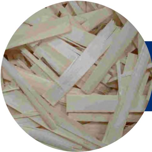
Der Original PALLMANN Langholz-Messerring-Zerspaner Typ PZU für die Zerspanung von Rundholz in "fallenden Längen" oder Fixmassen eignet sich in besonderem Maße für die Herstellung von Qualitäts-Strands für die OSB-Industrie und Engineered Wood Produkte (Konstruktionshölzern, LSL, CSL etc.).
