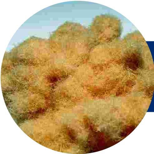
Die MDF-Faser wird in einem kontinuierlichen Verfahren erzeugt, bei der Holzhackschnitzel unter Dampfdruck mechanisch zerfasert wird. Die Auflösung des Hackschnitzels in Einzelfasern erfolgt zwischen einer rotierenden und einer feststehenden mit Mahlsegmenten bestückten Scheibe des PALLMANN Druckrefiners unter
