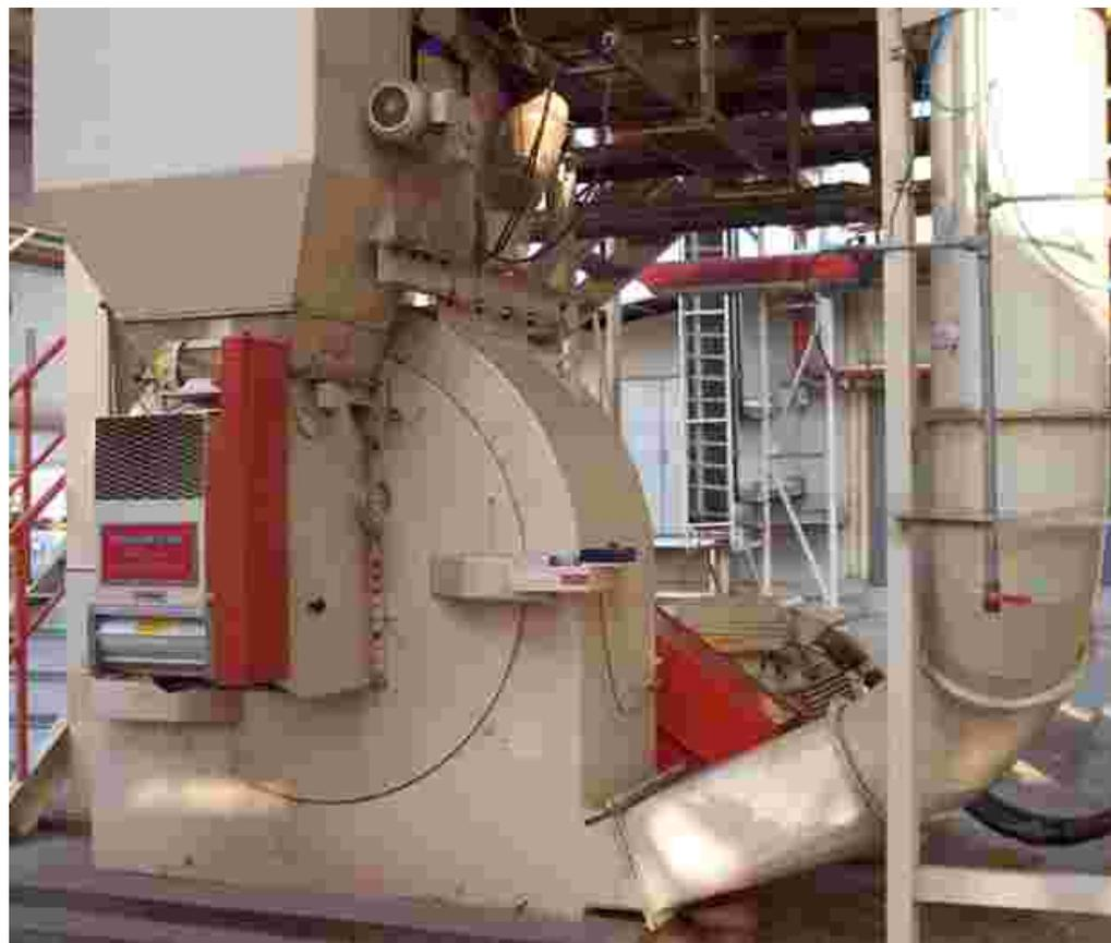
Schlagleisten und Mahlrippen zerkleinert wird. Eine Regulierung des Endmaterials kann durch gezielten Einsatz unterschiedlicher Mahlbahnprofile bzw. Mahlsichtungen erzielt werden.
