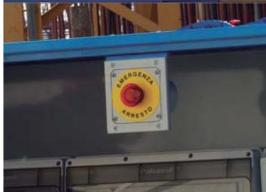
El pulsador de emergencia está posicionado en el centro del armario, estando siempre visible y accesible incluso con las puertas cerradas para garantizar la máxima seguridad y posibilidad de accionamiento.
