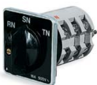
Conmutador para voltímetro de cuadro con placa negra en aluminio anodizado (esquema cam 19) IP65
