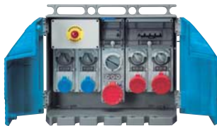
Cuadros de obra ASC con bases con interruptor y protección por fusibles entrada por bornero 50-60Hz IP65
