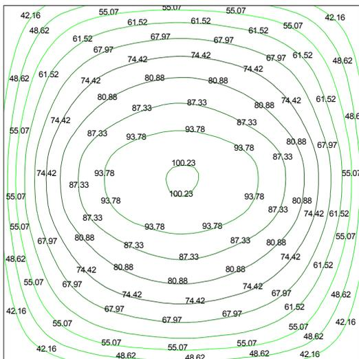
Iluminación referida al **SLED-600** expresada en lux, en una habitación con dimensiones de 15m x 15m con un proyector en posición perpendicular a 15m de distancia.
