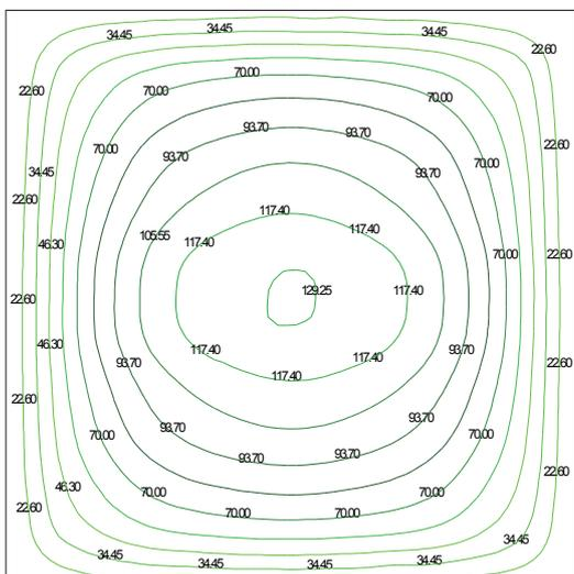
Iluminación referida al **SLED-400** expresada en lux, en una habitación con dimensiones de 15m x 15m con un proyector en posición perpendicular a 13m de distancia.
